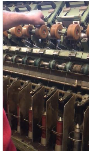
Un tube en train d'être changé par un opérateur
