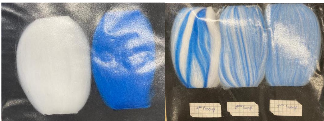
A gauche, les deux rubans de matière initiale. A droite, les rubans mélangés, au fil des différents passages en doublage-étirage
