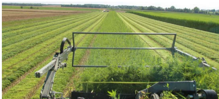
Le chanvre est fauché par la faucheuse automotrice Hyler Sativa 200. © PS
