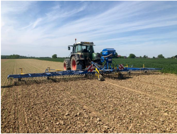
Photo 8 : Herse étrille Treffler (LCBio)
