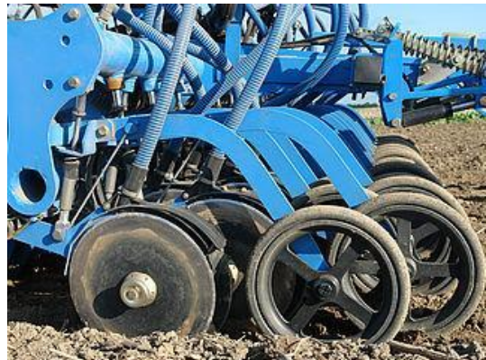
Photo 3 : Roues plombeuses sur semoir Lemken
