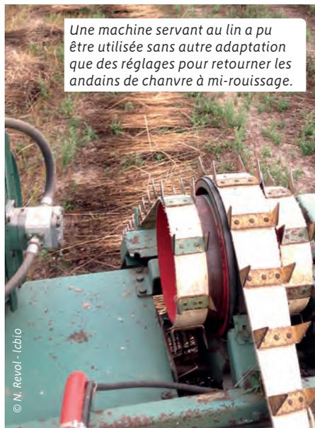
Une machine servant au lin a pu être utilisée sans autre adaptation que des réglages pour retourner les andains de chanvre à mi-rouissage.
